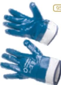
Предназначены для защиты рук от общепроизводственных загрязнений, механических воздействий, растворов кислот и щелочей (40-50%), неорганических растворителей, спиртов, продуктов нефтепереработки (нефти, бензина, масел, нефтесодержащих жидкостей). Водонепроницаемые.
